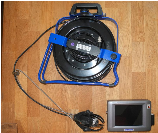
Abbildung 16 Endoskop (Monitor, Kamera, Kabelhaspel)
